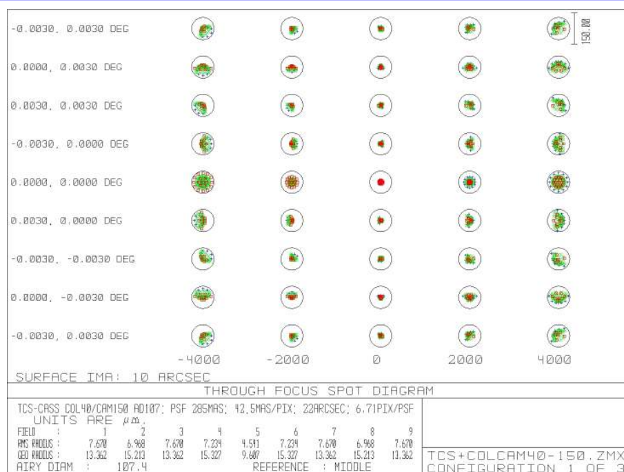
Figura 4.4: Diagrama de manchas «a través del foco» correspondiente al Diseño Óptico conseguido para el detector de 512 \times 512 pix.
