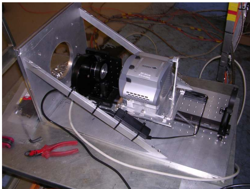
Figura 4.12: Primera instalación de FastCam en NOT con la nueva estructura «itinerante». Se puede notar que todavía mantiene el sistema óptico antiguo con la rueda de filtros manual pero con el detector nuevo de 512 \times 512 píx.
