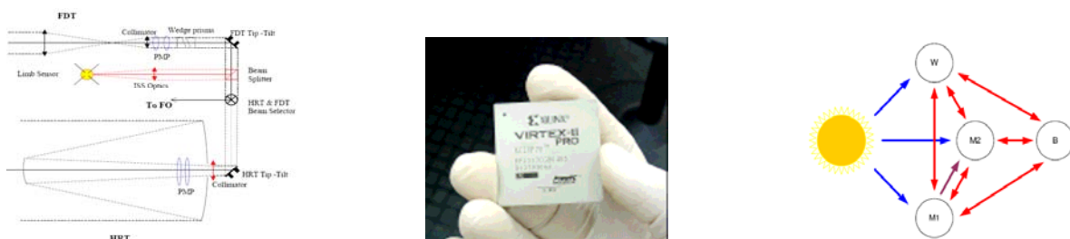
Figura 12: Izquierda: Concepto actual de VIM que incluye los ROCLIs (PMP). Centro: FPGA del prototipo de inversor electrónico. Derecha: Nodos del modelo térmico de VIM.
