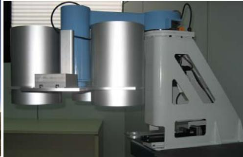
Sistema robótico para calibración del plano focal de ALMA (Atacama Large Millimeter Array)
