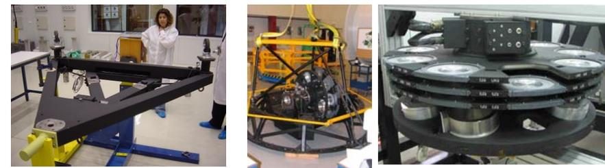
Ruedas de filtros y estructura del colimador para el Optical System for Imaging and Low Resolution Integrated Spectroscopy (OSIRIS) del GTC
