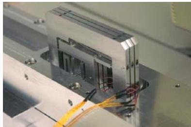
Electrónica, control y cableado para la Configurable Slit Unit (CSU) del Espectrógrafo Multiobjeto Infrarojo (EMIR) del GTC
