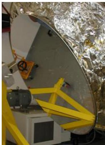
Ya se ha iniciado el proceso de aluminizado de los espejos del GTC. El espejo terciario, M3, fue realuminizado el pasado mes de abril y en mayo se iniciará el de los segmentos del espejo primario (M1). Se trata de un proceso rutinario que se inicia tras la primera fase de Commissioning y puesta a punto. De ahora en adelante no sólo se realuminizarán los segmentos periódicamente, sino que se utilizará de forma habitual una espuma especial (nieve de CO<sub>2</sub>) para su limpieza.
