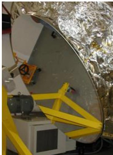
Ya se ha iniciado el proceso de aluminizado de los espejos del GTC. El espejo terciario, M3, fue realuminizado el pasado mes de abril y en mayo se iniciará el de los segmentos del espejo primario (M1). Se trata de un proceso rutinario que se inicia tras la primera fase de Commissioning y puesta a punto. De ahora en adelante no sólo se realuminizarán los segmentos periódicamente, sino que se utilizará de forma habitual una espuma especial (nieve de CO2) para su limpieza.
